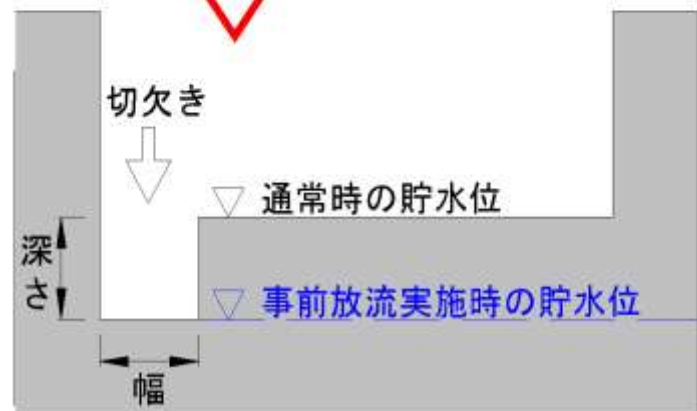
余水吐越流堰の切欠きイメージ図
